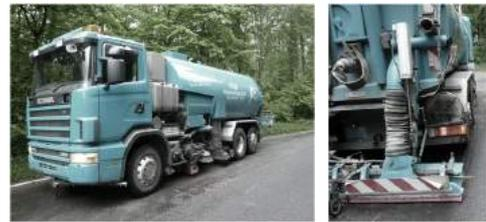
Reinigungsfahrzeug für Trocken- und Nassreinigung, inkl. Heckabsaugbalken
